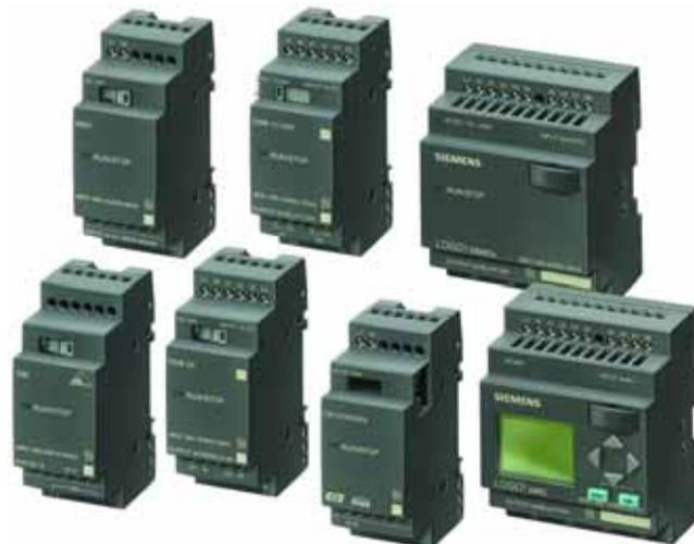
Все встроенные входы модулей могут использоваться для ввода дискретных сигналов. Напряжение питания входных цепей соответствует напряжению питания модуля. В модулях номинала питания 12/24В AC 2 из 8 входов имеют универсальное назначение. Они могут использоваться для ввода дискретных сигналов или аналоговых сигналов 0...10В.
